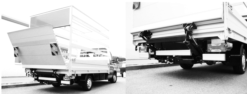
Figura 1. Esempio di sponda idraulica
