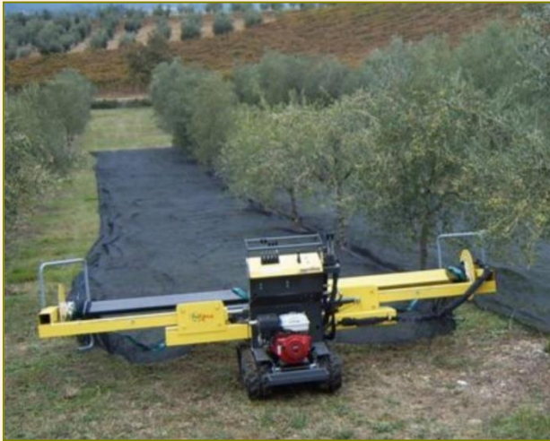
Sistema di stesura e recupero dei teli con aspo avvolgitore (RIDING 2007).
