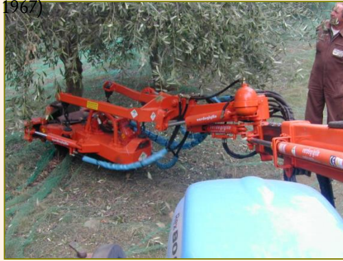
Scuotitore: particolare della pinza e del sistema di sospensione.
