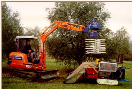
La pettinatrice CRF OliveONE: adotta un innovativo sistema idraulico che permette di controllare ampiezza frequenza e rotazione dell’aspo pettinatore.
