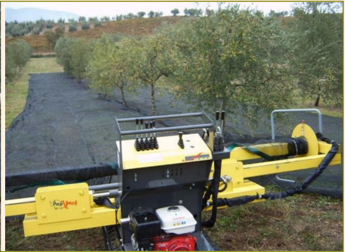
Sistema di stesura e recupero dei teli con aspo avvolgitore (RIDING 2007).
