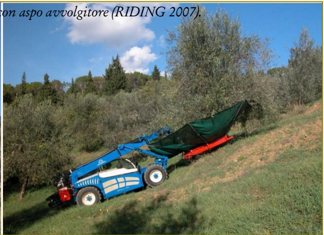
Testata scuotitrice integrata da ombrello rovescio montati su trattore reversibile.
