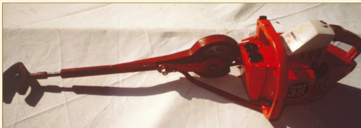
Scuoti-battitore vibrante da applicarsi in sostituzione della barra guidalama di una qualsiasi motosega o simili -
