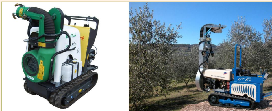
Irroratrice semovente con diffusore a cannone per il trattamento di impianti di difficile accesso.
