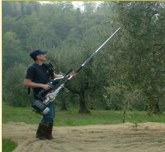
Pettine battitore a denti orbitanti – DIAF 1988 (Brevetto 1198718)
