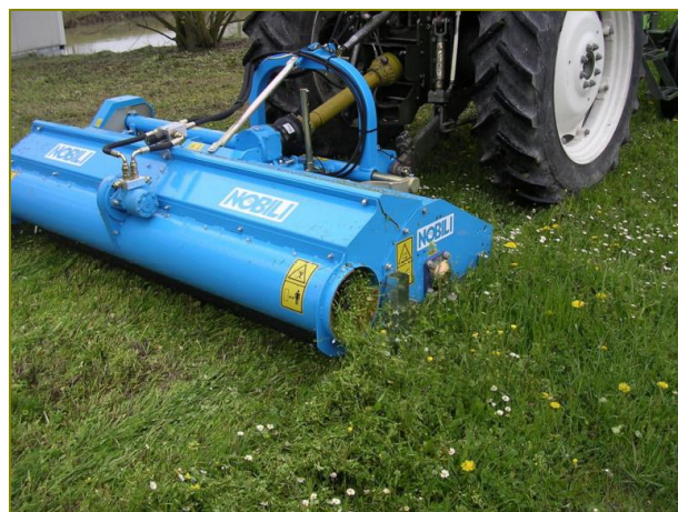
Trinciaerba portato da trattore e semovente di piccole dimensioni per i terrazzamenti.
