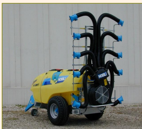
Moderna irroratrice a getti mirati dotata di doppio circuito irrorante per la distribuzione contemporanea di trattamento antiparassitario e concimazione fogliare.
