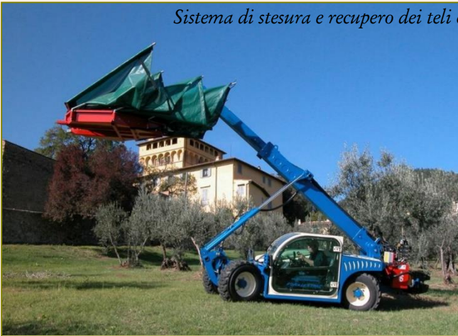
Testata scuotitrice integrata da ombrello rovescio montati su trattore reversibile.
