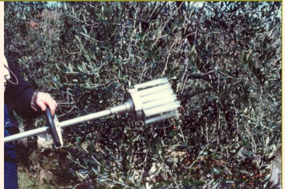
Pettine battitore a denti orbitanti – DIAF 1988 (Brevetto 1198718)
