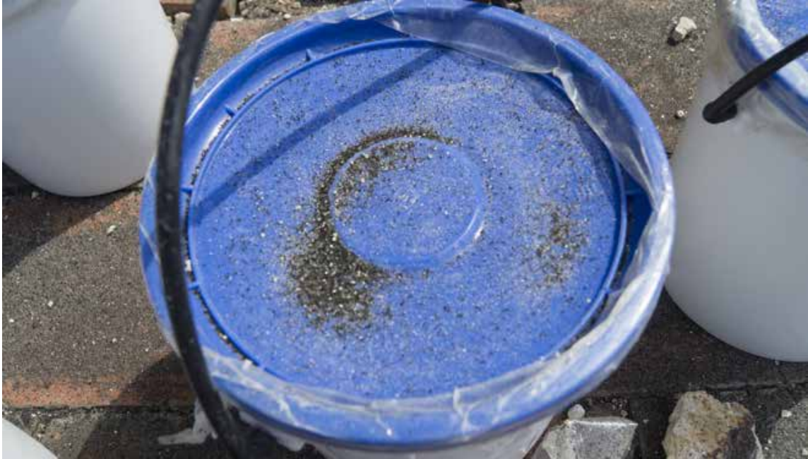
Figura 2: Deposito di arena silice e componente abrasiva in ferro
