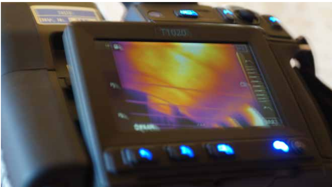
Figura 5: Immagine termografica su BLOCCO 5. Viene evidenziata la presenza di alcuni elementi “tipo nervature” o ferri sulle volte
