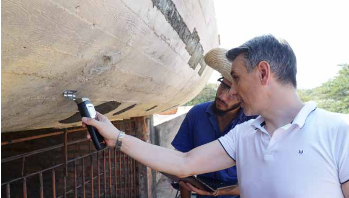
Figura 12: Rilevamento dell'umidità superficiale (profondità 3/5 cm c.a.)
