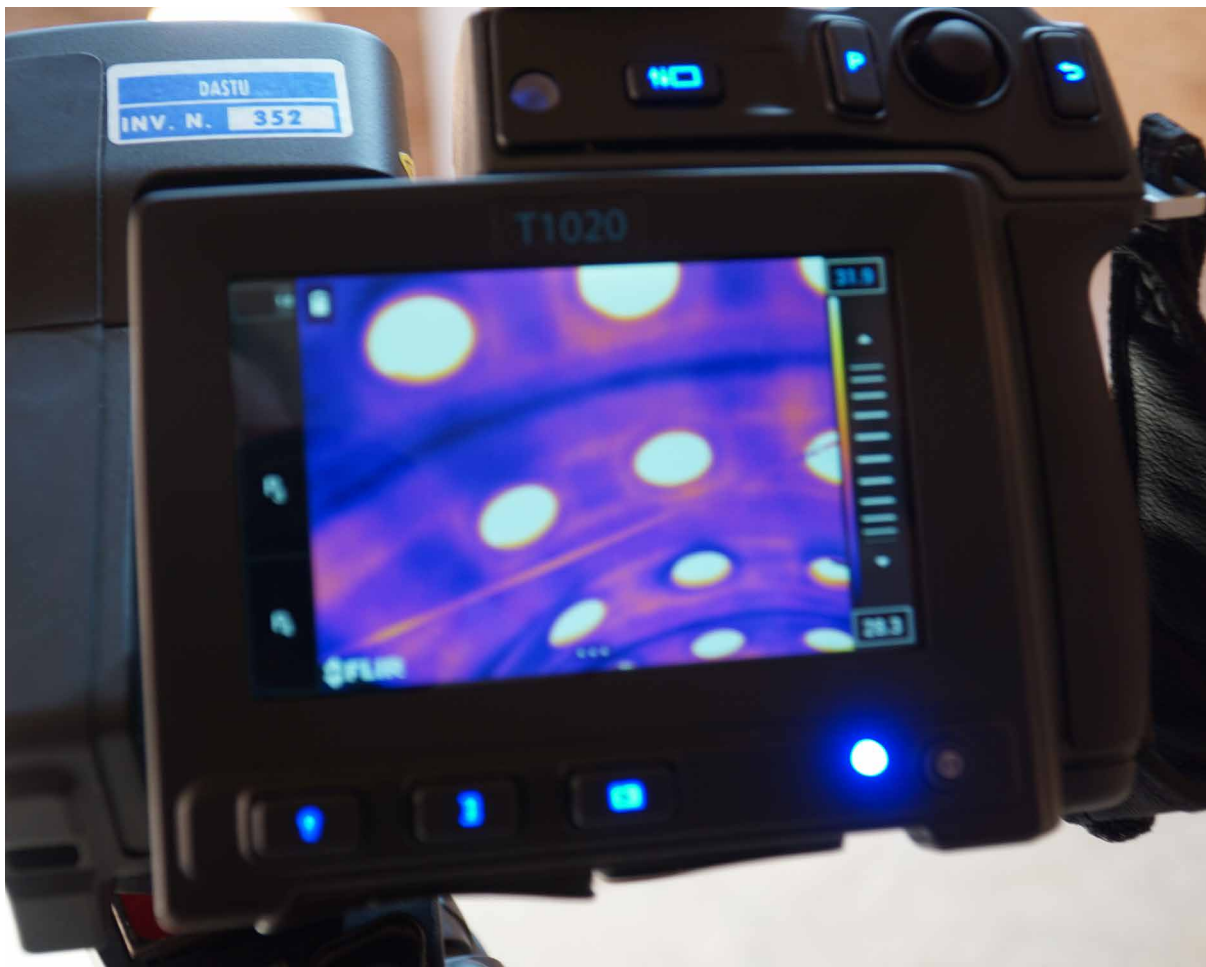
Figura 2 | Sara Garuglieri, imagen termográfica del intradós de la bóveda del “bloque 9” realizada por por el Arq. Luca Valisi del Politécnico de Milán en colaboración con Arch. Garuglieri. De la foto se destacan con colores más claros algunos elementos que sugieren la presencia de costillas tangente a los tragaluces. Las bandas más oscuras visible en la foto identificar en su lugar hileras de ladrillos exteriores yuxtapuestos en los extrados de la bóveda, 19.02.2020.
