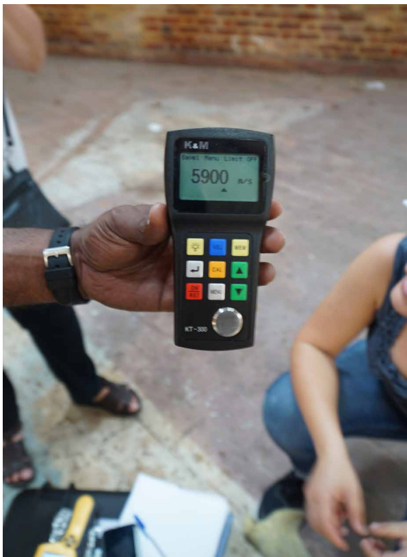
Bloque 11 Prueba de medición de espesor por ultrasonidos (no realizada)
