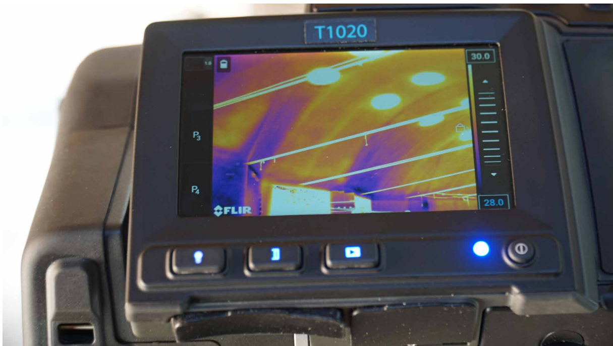
Figura 6 | Imagen termográfica en el BLOQUE 11. Destaca la presencia de algunos elementos “tipo costilla” tangentes a los lucernarios.
