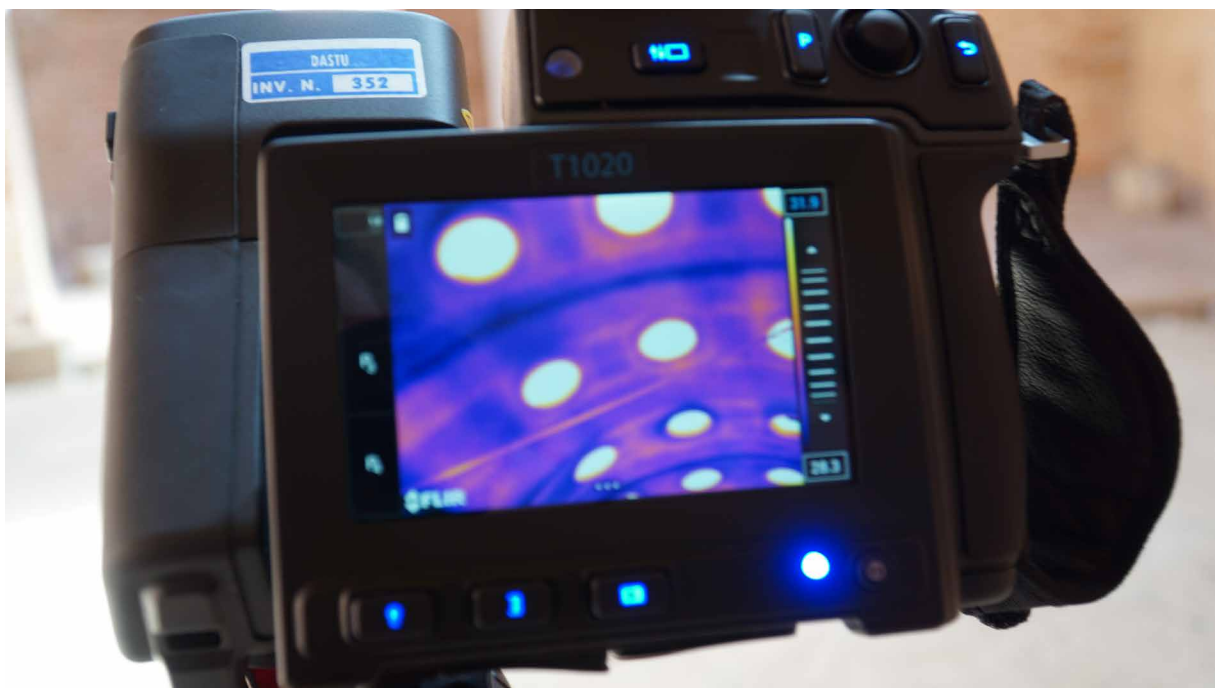
Figura 8 | Imagen termográfica en el BLOQUE 9. Destaca la presencia de algunos elementos “tipo costilla” tangentes a los lucernarios, mientras que las bandas más oscuras se encuentran en correspondencia con las hileras de ladrillos exteriores yuxtapuestas a las bóvedas.
