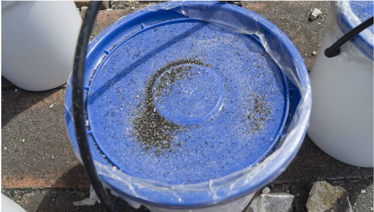
Figura 2 | Depósito de sílice de arena y componente abrasivo de hierro.
