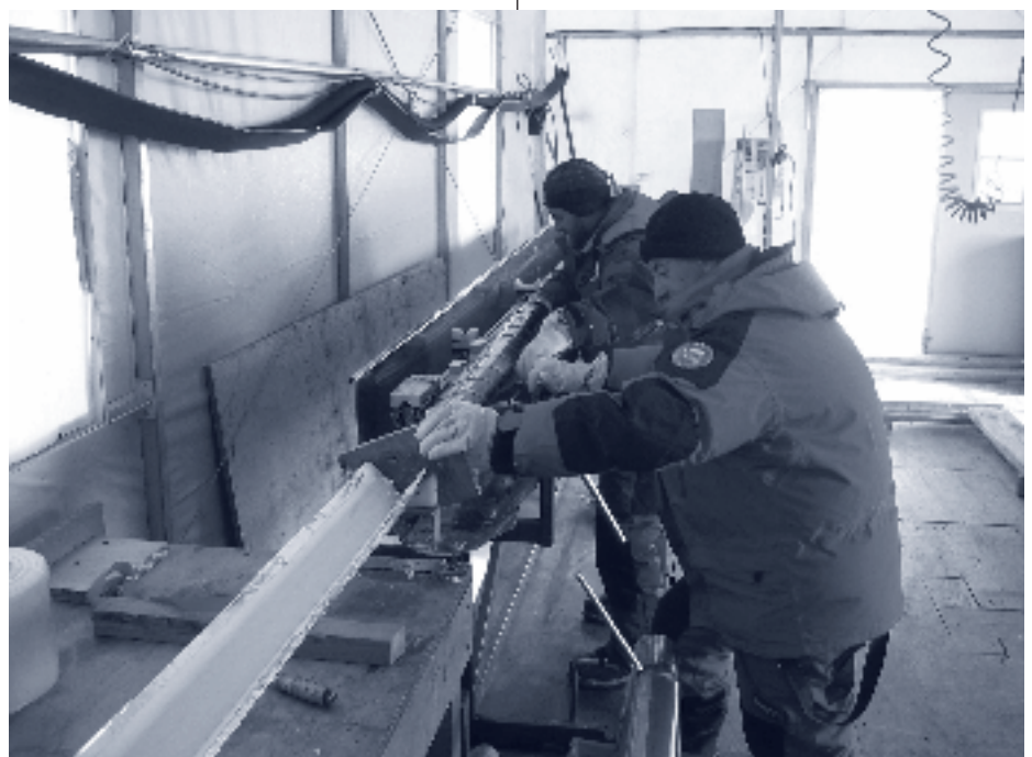
Estrazione della carota di ghiaccio dal tubo carotiere nella tenda di perforazione a Dome C
