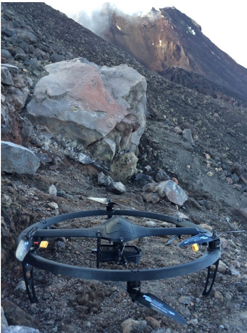
Drone Saturn Mini (carico utile / payload 1,5 kg; autonomia / autonomy 30 min; velocità massima / maximum speed 90 Km/h; rateo salita / climb rate 10 m/s; rateo discesa / descent rate 6 m/s).
