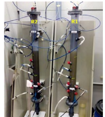
Impianti a scala di laboratorio per l'applicazione di processi innovativi per il trattamento di acque reflue municipali e industriali, sviluppati nei laboratori di UNIFI, in collaborazione con partner accademici italiani / Lab-scale plant applying innovative processes for municipal and industrial wastewaters, developed at UNIFI laboratories in collaboration with other national academic partners
