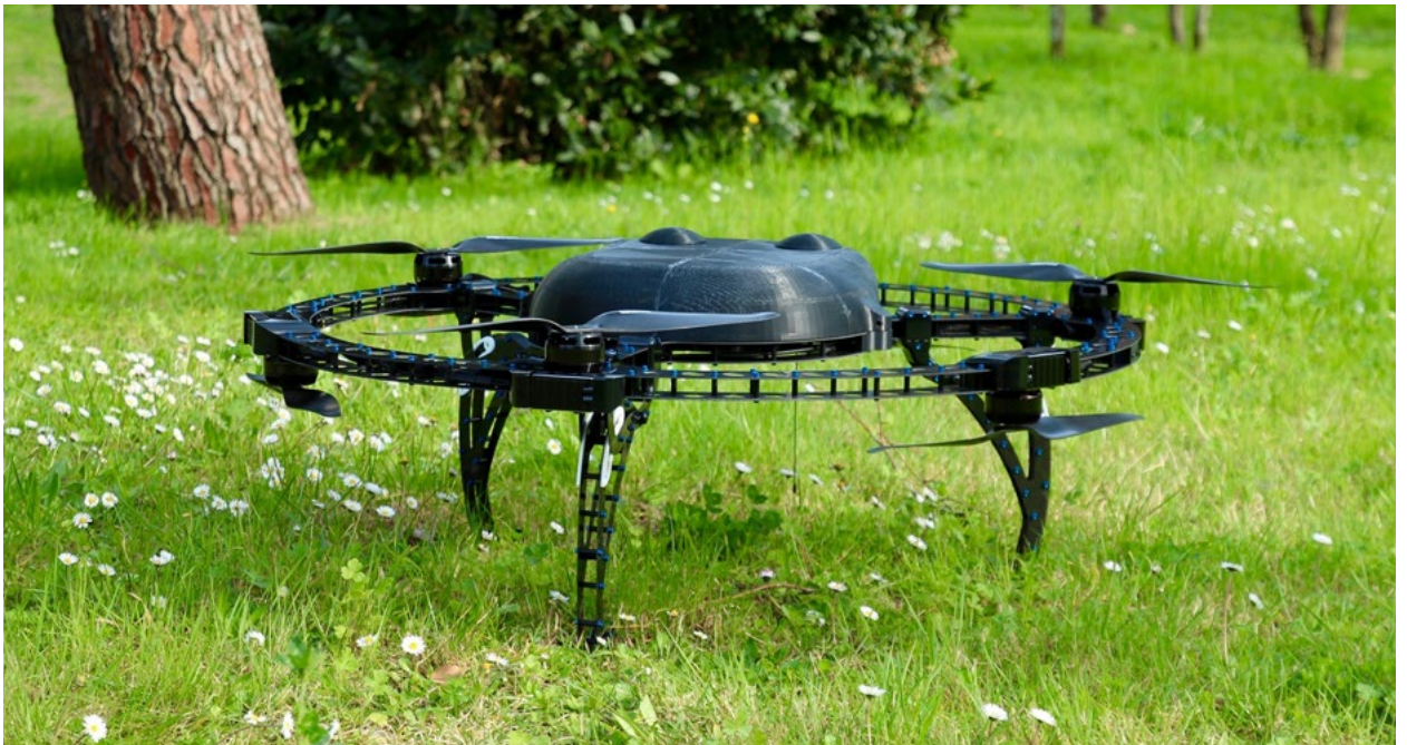
Drone Saturn (carico utile / payload 10 kg; autonomia / autonomy 30 min; velocità massima / maximum speed 65 Km/h; rateo salita / climb rate 12 m/s; rateo discesa / descent rate 6 m/s).
