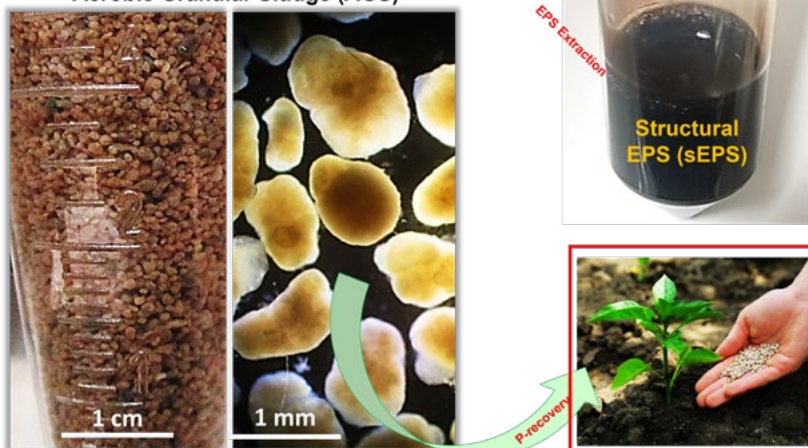
Recupero di EPS da fanghi granulari aerobici / EPS recovery from aerobic granular sludge
