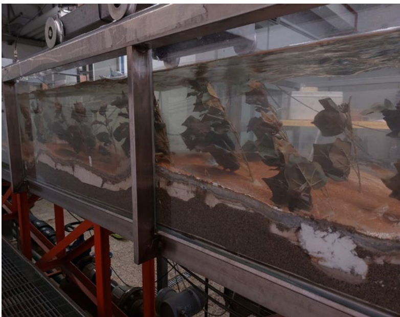
Canaletta fluviale con vegetazione flessibile per studi sull'interazione corrente-vegetazione (Sx) e plastica-vegetazione / Laboratory flume with flexible vegetation to investigate the flow-vegetation (on the left) and the plastic-vegetation (on the right) interactions
