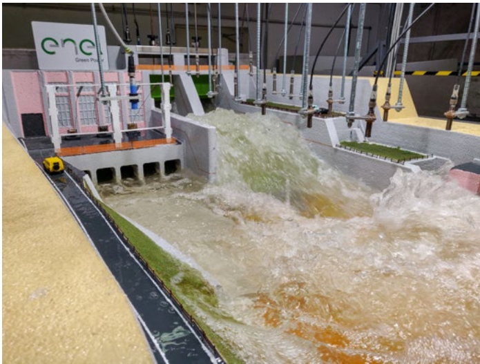
Modello fisico del progetto di rialzo della Diga di Levane (AR), sul fiume Arno, in scala 1:40 / Physical model of the project to raise the height of the Levane Dam (AR), on the Arno River, on a scale of 1:40
